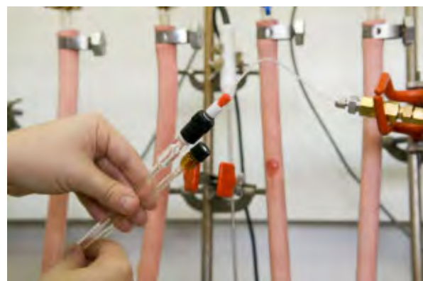
>>> Tube de résonance magnétique nucléaire (RMN) sous pression utilisé pour suivre la réaction d'hydrogénation catalytique du benzonitrile
