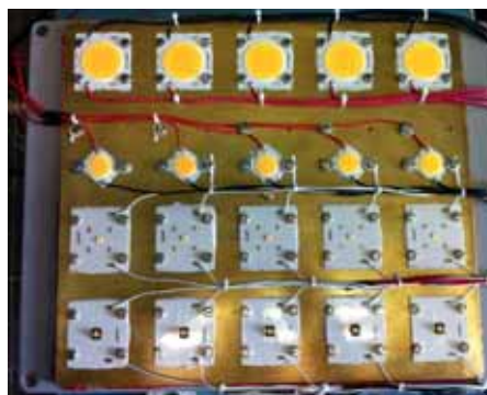
Banc prototype de vieillissement contrôlé des LEDs au LAPLACE et son comportement thermique.
