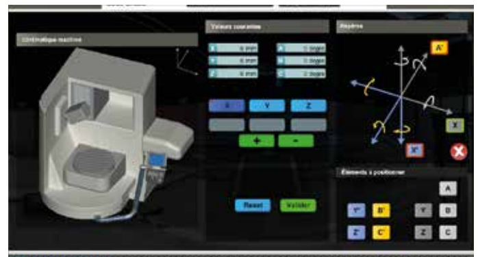
Identification des axes d'une machine-outil dans Mecagenius http://mecagenius.univ-jfc.fr/ © KTM advance et SGRN
