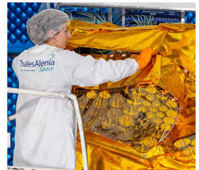
Camille est en chambre anéchoïque où elle fait la mesure de performances électromagnétiques d'une antenne en champ proche.
