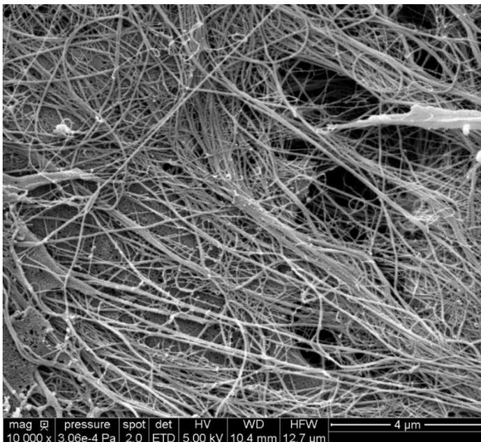
**Fibres de collagène dans une peau humaine artificielle utilisée dans cette étude, observées au microscope électronique à balayage.**
